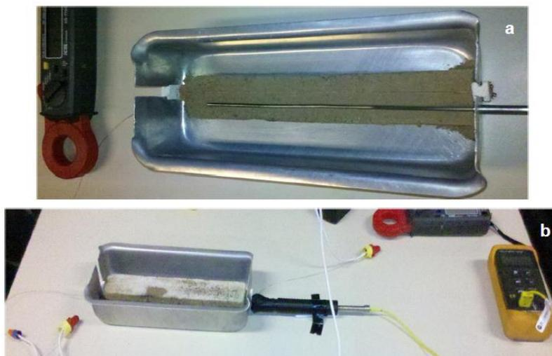
**Figura 12 - (a) A resistência está fixada e isolada térmica e eletricamente, em um suporte de alumínio para melhor manuseio, juntamente com o termopar e separados a uma distancia fixa de 16 mm, a condutividade térmica para o material foi determinada para temperatura ambiente, sendo considerada a importância de máximo contato entre as peças (b).**
