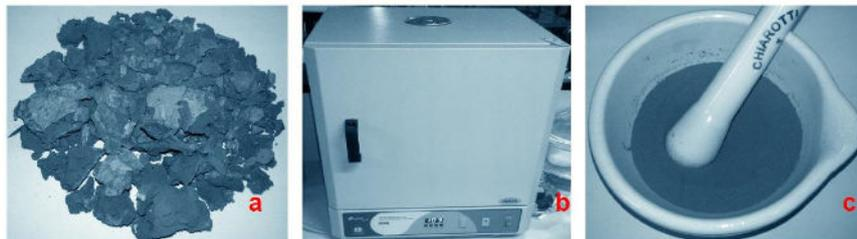
**Figura 1 - Sequência de preparação da matéria prima a) fragmentação do lodo, b) secagem e c) moagem do lodo.**
