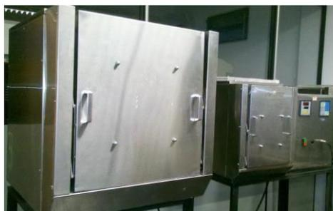
**Figura 3 - Forno resistivo utilizado nas diversas queimas realizadas.**
