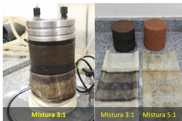
**Figura 6. Corpos-de-prova das misturas 3:1 e 5:1 utilizados no ensaio de permeabilidade.**
