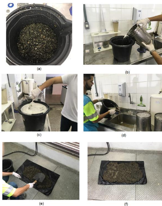
Figura 8: Etapas do procedimento de coleta e preparo das amostras. Fonte: Consórcio ENGECORPS-SHS, 2018.
