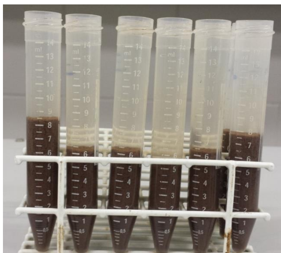
Figura 3: Preparação dos tubos graduados com fundo cônico utilizados nos ensaios de centrifugação com lodo e polímero para realização dos ensaios de desaguamento em centrífuga.
