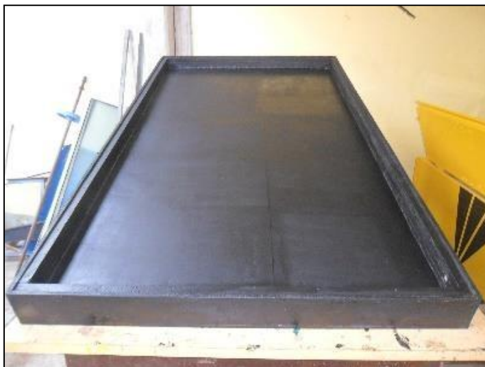
Figura 15 - Caixa do coletor pronta para receber a grade absorvedora
