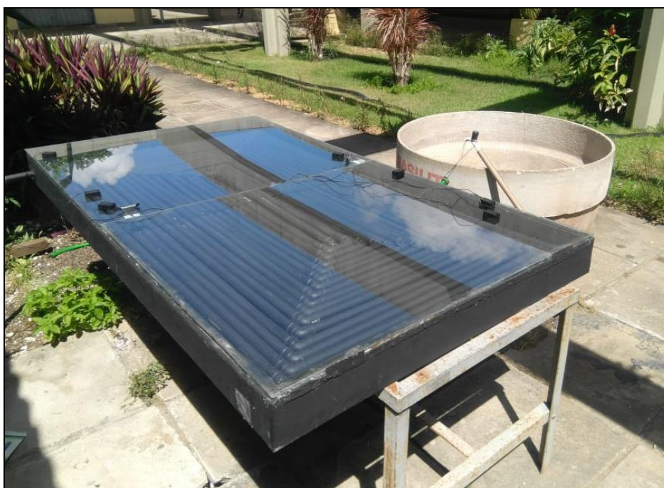
Figura 18 - Coletor solar em labirinto completamente montado e pronto para ensaio
