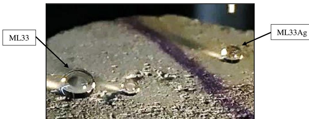
**Figura 2: Gotas sobre a superfície de concreto revestido – a esquerda ML33 e a direita ML33Ag**
