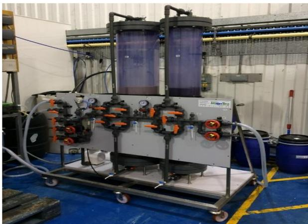
**Figura 26: Equipamento para troca Iônica** <sup>5</sup>.
