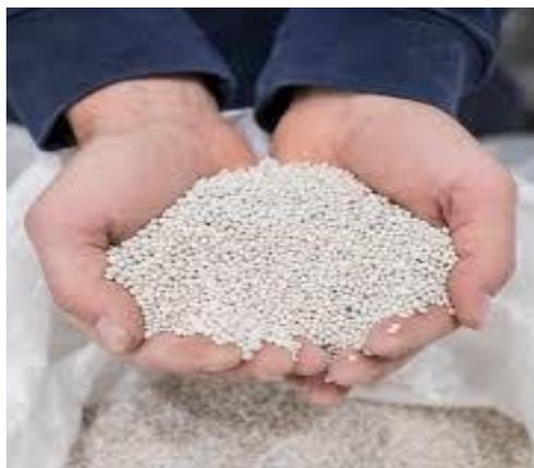
Figura 14: Estruvita proveniente da Tecnologia SMARTech5 <sup>23</sup>.
