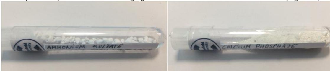
**Figura 15: Recuperação de Nutrientes: Sulfato de Amônia e Fosfato de Cálcio <sup>5</sup>.**
