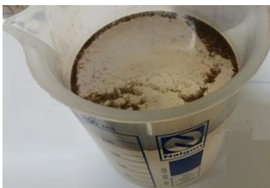
Figura 26 – Formação de flocos com polieletrólito convencional.
