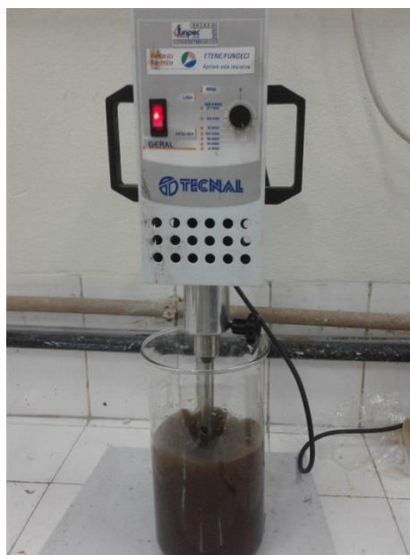
Figura 18 – Sistema de agitação para formulação de água produzida sintética.
