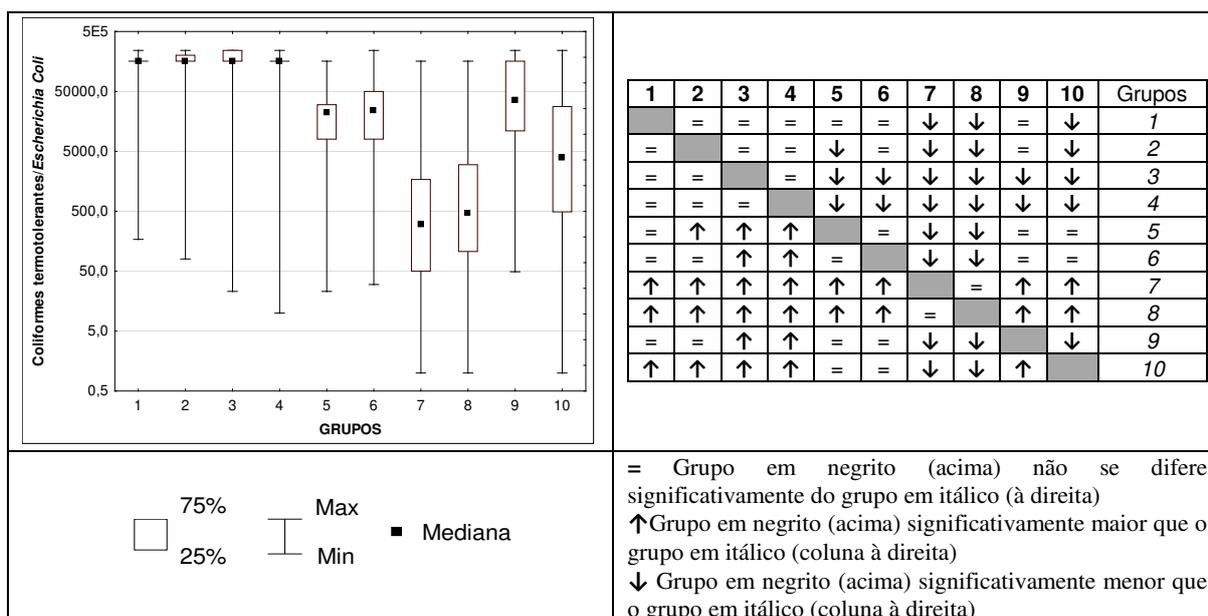
**Figura 3: Box-plot das concentrações do parâmetro coliformes termotolerantes/*Escherichia coli* e resultados do teste de comparações múltiplas, após diferença significativa indicada pelo teste de *Kruskal-Wallis* ( $p < 0,05$ ), considerando os agrupamentos formados na AC.**
