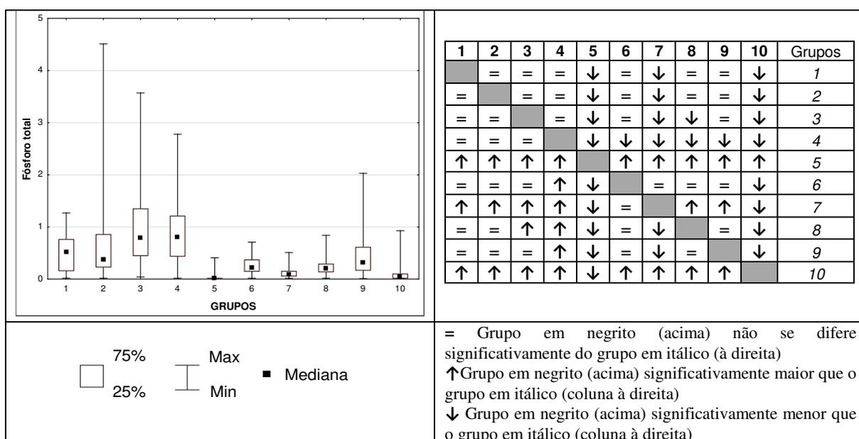
**Figura 4: Box-plot das concentrações do parâmetro fósforo total e resultados do teste de comparações múltiplas, após diferença significativa indicada pelo teste de *Kruskal-Wallis* ( $p < 0,05$ ), considerando os agrupamentos formados na AC.**
