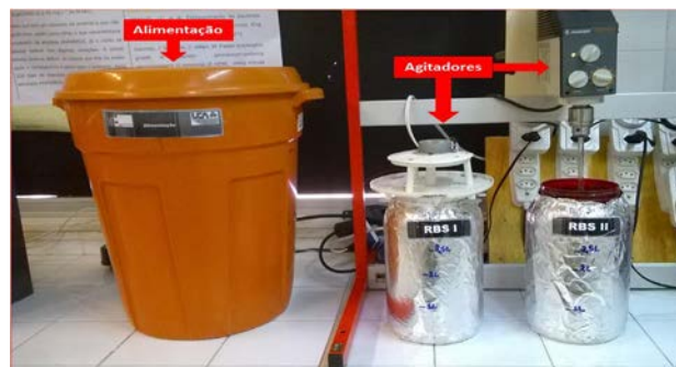
Figura 1- Aparatos operacionais dos reatores RBS I e RBS II
