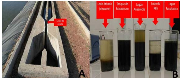
Figura 2- (A) Local da coleta do esgoto municipal (B) Perfil dos lodos utilizados para inocular o RBS II
