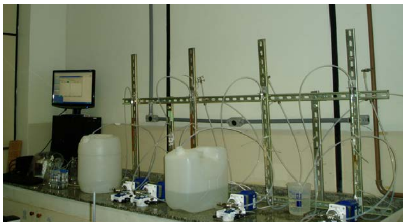
Figura 2 : Aparato experimental para os testes de ciclo de saturação das resinas catiônicas e aniônicas.
