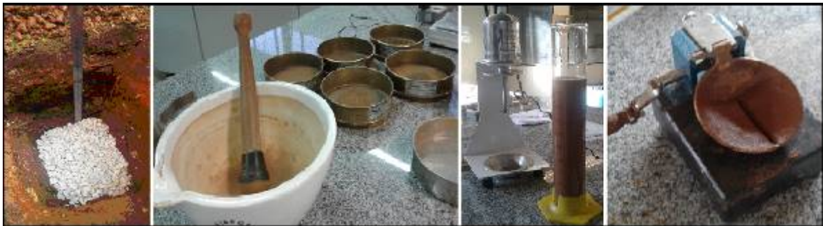
Figura 4 - Ensaios de percolação, granulometria, limite de liquidez.
