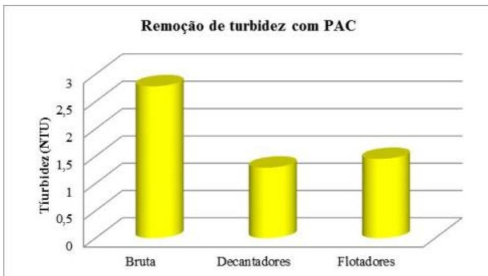
**Figura 12 – Remoção de turbidez obtida com aplicação de PAC**
