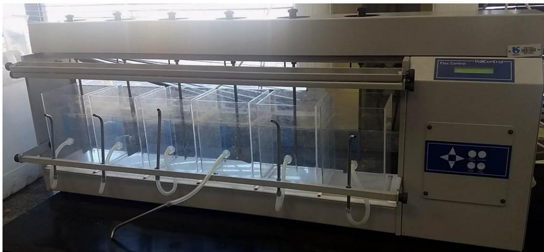
**Figura 2 – Equipamento jar test modelo Floc control III**
