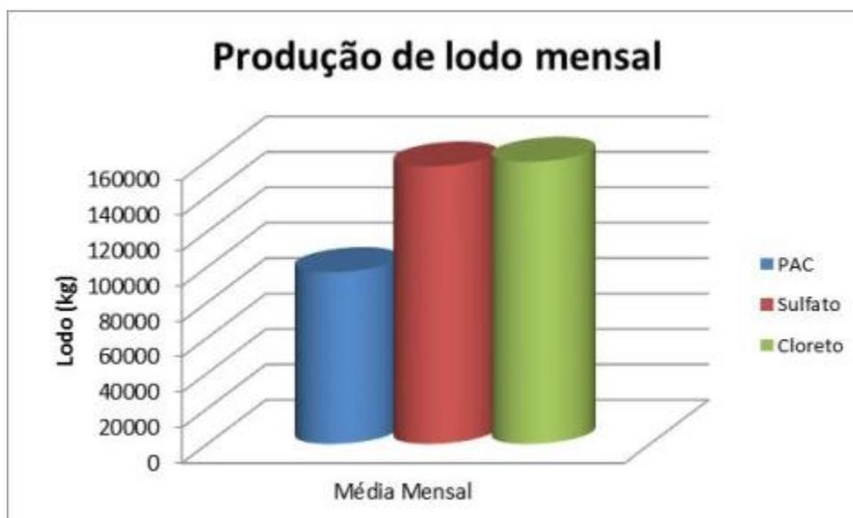
**Figura 15 – Quantidade de lodo gerado Sulfato Férrico x PAC**
