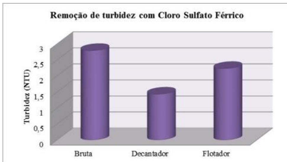
**Figura 10 – Remoção de turbidez obtida com aplicação de Cloro Sulfato Férrico**
