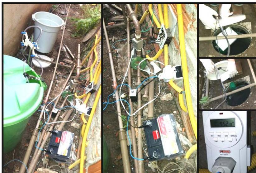
Figura 1: Sistema de amostragem composta utilizada na coleta do efluente líquido.
