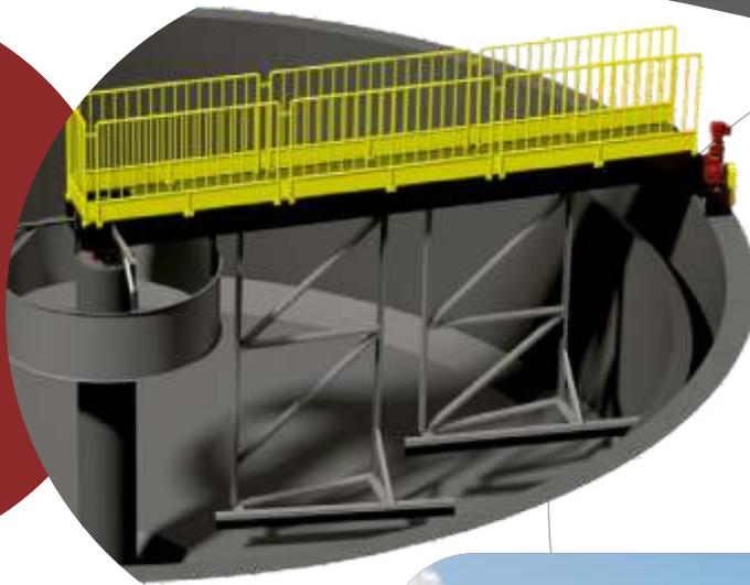
Promove a retirada do lodo sedimentado por meio de raspadores com movimento circular. Instalada em tanque cilíndrico, possui calha coletora periférica para líquido clarificado e acionamento periférico ou central através de motoredutor de engrenagens helicoidais e eixos paralelos. Os braços raspadores são acoplados ao eixo central por meio de articulações as quais possibilitam a regulagem de altura e ângulo de inclinações dos mesmos.
