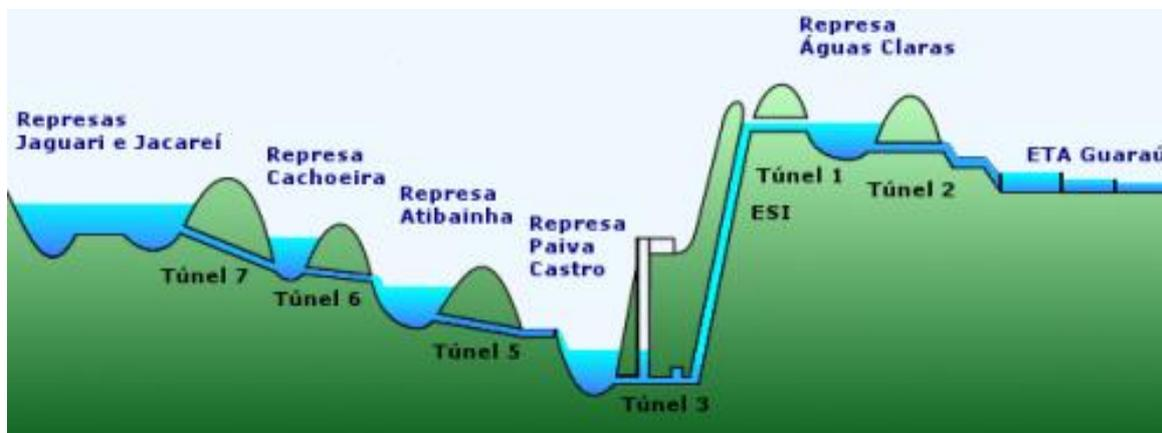
**Figura 2 - Sistema Cantareira - Perfil hidráulico.**
