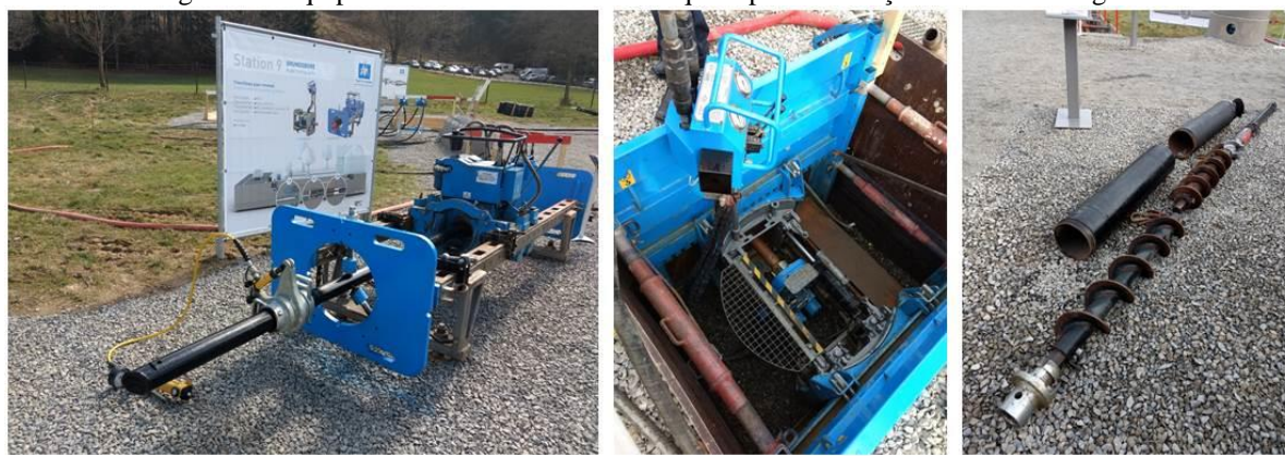
Figura 3 – Equipamento “Grundobore” – Máquina para instalação de redes de esgoto.
