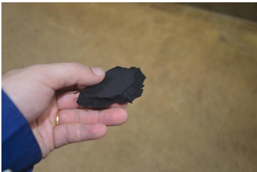
Figura 3.10: Torta de lodo do Filtro Prensa de Esteira da Planta Blue Plains da DC Water com 30% de TS
