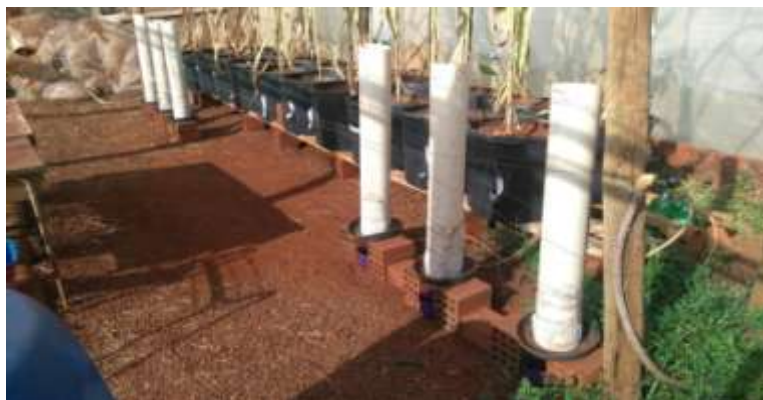
Figura 3: Colunas de solo instaladas na estufa de crisântemo para condução do experimento.
