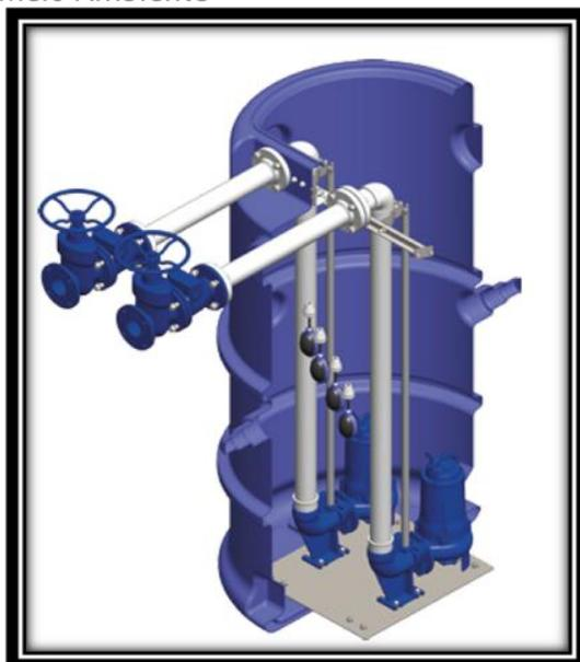
**Figura 01: Unidade de Transferência vista em corte.**
