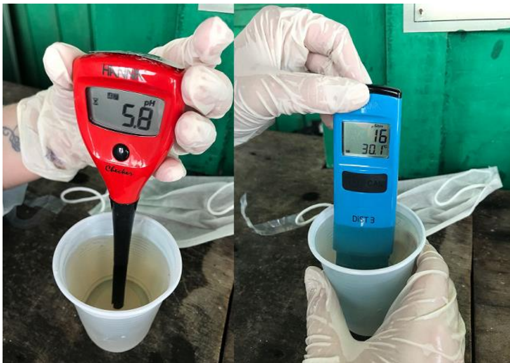
Figura 6: Ensaios de pH, condutividade e temperatura sendo realizados in loco.
