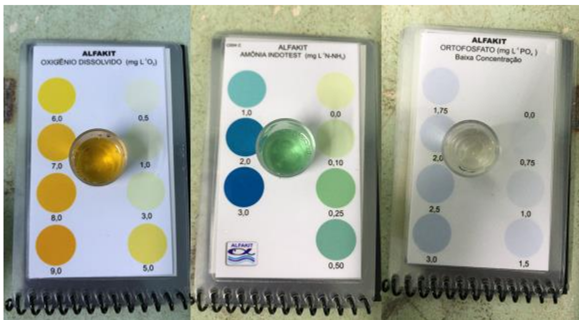
Figura 7: Análise dos resultados de Oxigênio Dissolvido, Amônia e Ortofosfato de uma das amostras.
