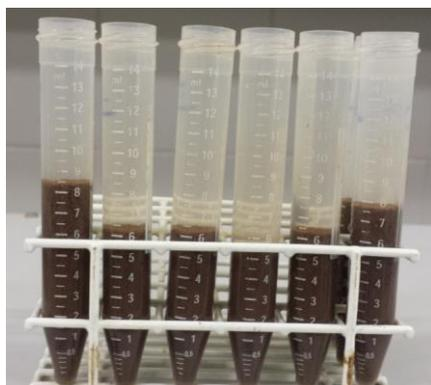
**Figura 2: Preparação dos tubos graduados com fundo cônico utilizados nos ensaios de centrifugação com RETA 2 e polímero para realização dos ensaios de desaguamento em centrífuga.**
