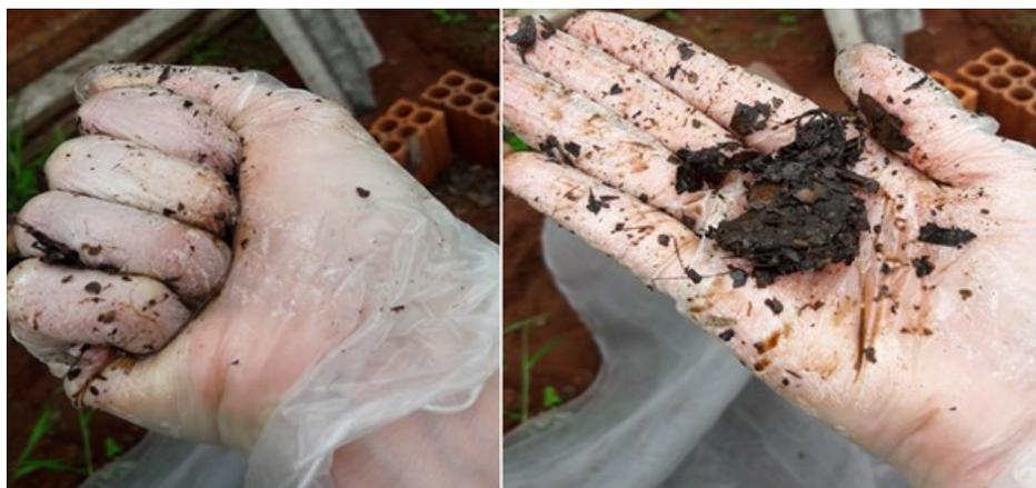
**Figura 08: Teste sensorial de umidade na compostagem.**
