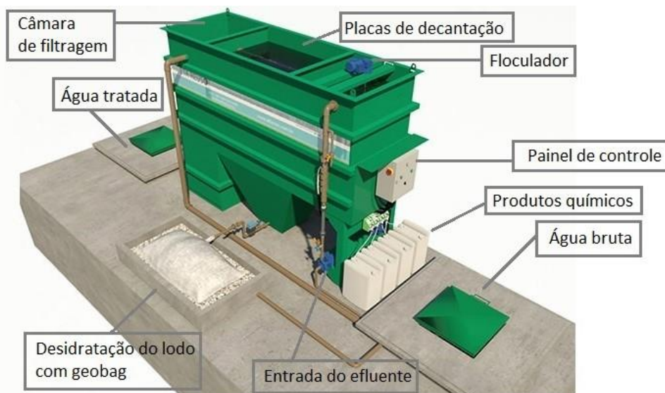
Figura 3: ETA de reuso com reservatórios enterrados, modelo com vazões de 800 a 5.000 l/h.
