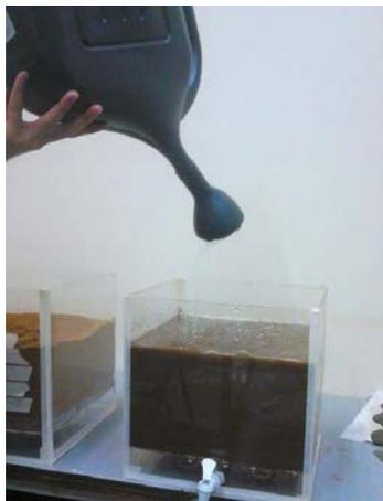
**Figura 2. Simulação da chuva com o regador na caixa de acrílico.**
