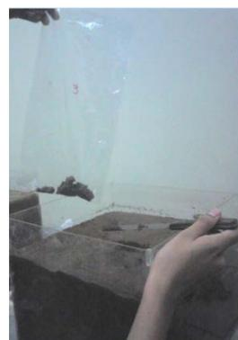
**Figura 4. Coleta de amostra do solo, após percolação da água da chuva artificial.**
