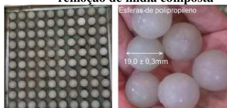
**Figura 37 - Esferas de polipropileno utilizadas no ensaio de transporte de sólidos e remoção de esferas**
