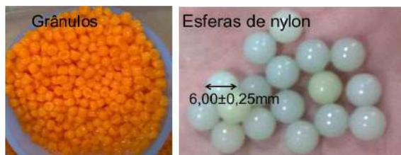
**Figura 38 - Grânulos e esferas de nylon utilizados no ensaio de remoção de grânulos**
