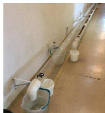
**Figura 14 - Tubo de simulação do ramal predial de esgoto**
