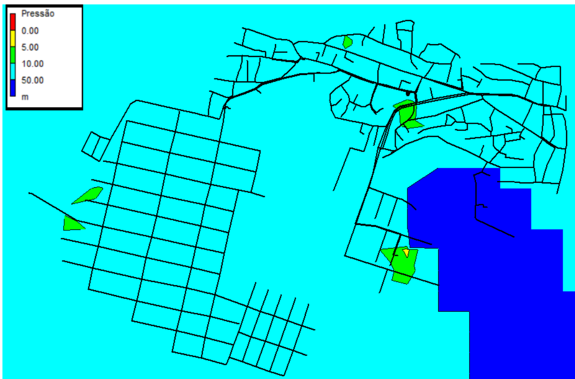
Figura 7: Mapa interpolado de zonas pressões na hora de pico de consumo (11:00h-12:00h).
