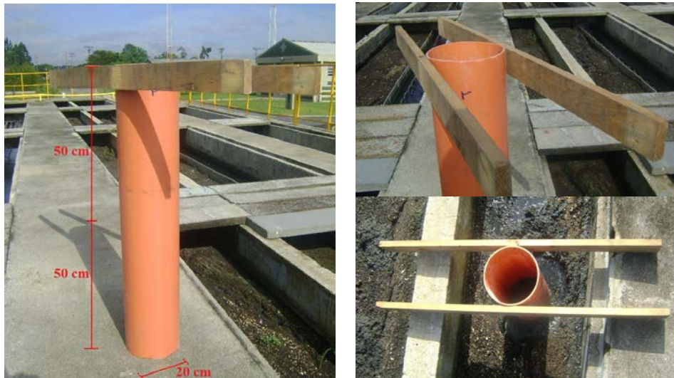
Figura 3: Fotografia do tubo armazenador de espuma. Fonte: os autores.
