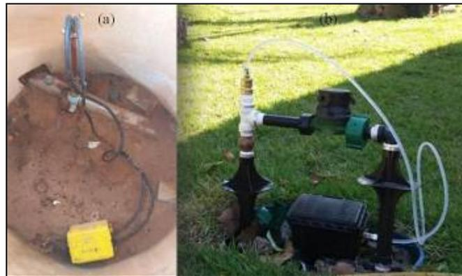
Figura 1: Equipamentos instalados no Rio Vermelho. (a) Maleta pitométrica (b) Datalogger de pressão.
