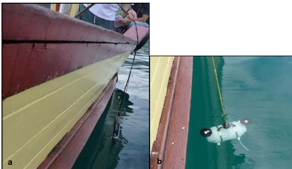
Figura 2: (a) Sonda multiparâmetros sendo utilizada na coluna d'água e (b) garrafa de Van Dorn utilizada para coleta de água salina.
