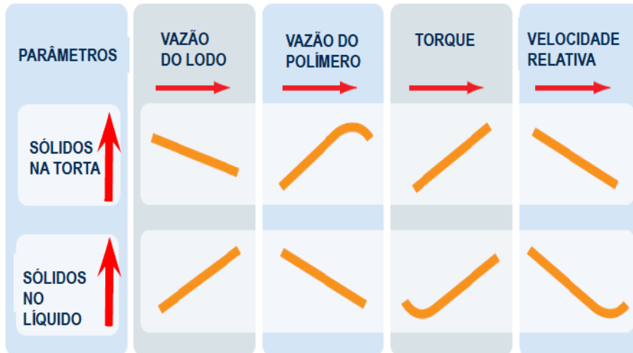
Figura 15: Efeito de parâmetros variáveis no resultado do desaguamento da centrifuga decanter.
