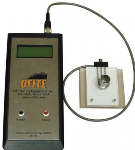
Figura 13.: “Capillary Suction Timer” da OFI Testing Equipment Inc., usado em laboratórios da Andritz.
