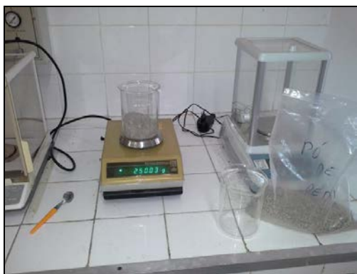
Figura 1: Pesagem para o teste de solubilização.
