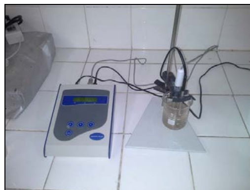
Figura 2: pHmetro e a medição.
