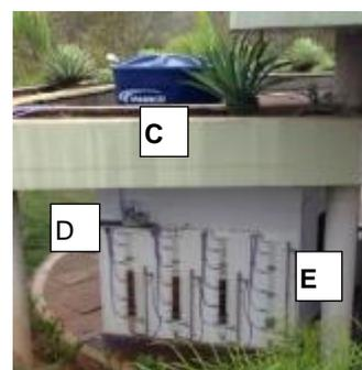
**Figura 4 (C) Reservatório, (D) bomba peristáltica e (E) colunas de acrílico**
