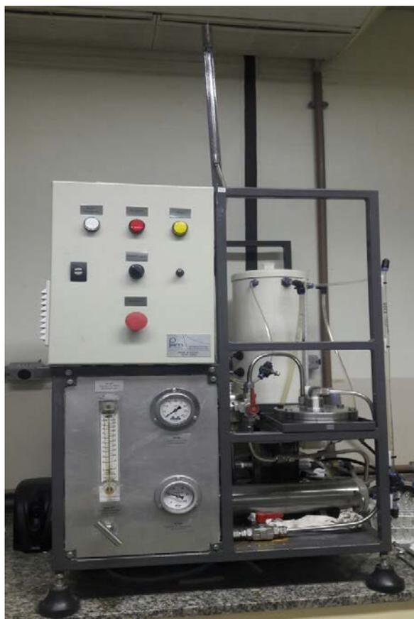
**Figura 2 – Sistema de Osmose Inversa.**
