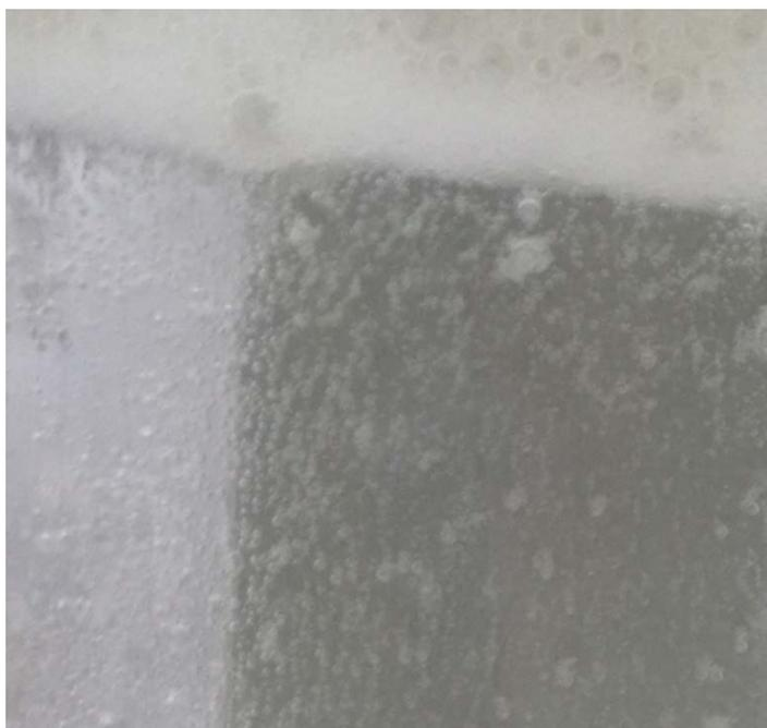
**Figura 2: Imagem do processo de eletrocoagulação ocorrendo com a separação de fases e formação das microbolhas.**
