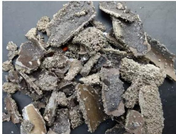
Foto 2 – Amostras de incrustação removidas manualmente no Condensador Evaporativo 4B após 45 dias de teste
