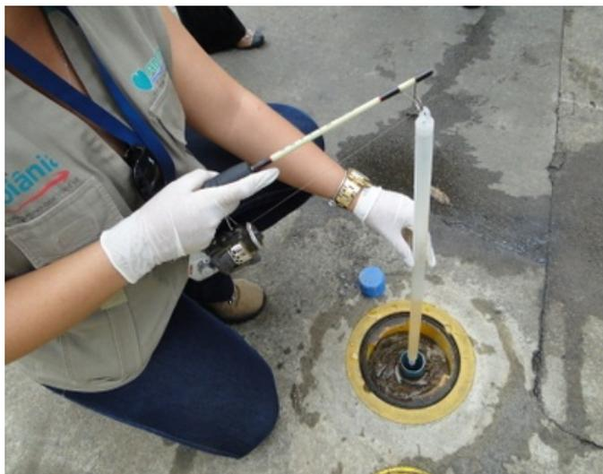
Figura 1: Um dos *bailers* utilizados na obtenção das amostras.
