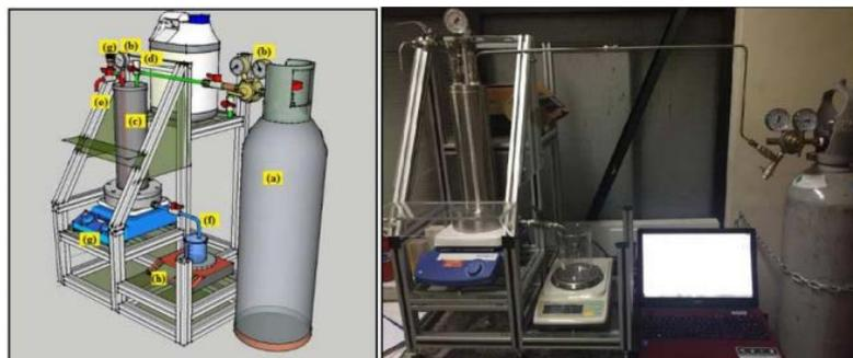
**Figura 2: Sistema *dead-end* para PSM com membranas de OI (adaptado de: SILVA, 2016).**
