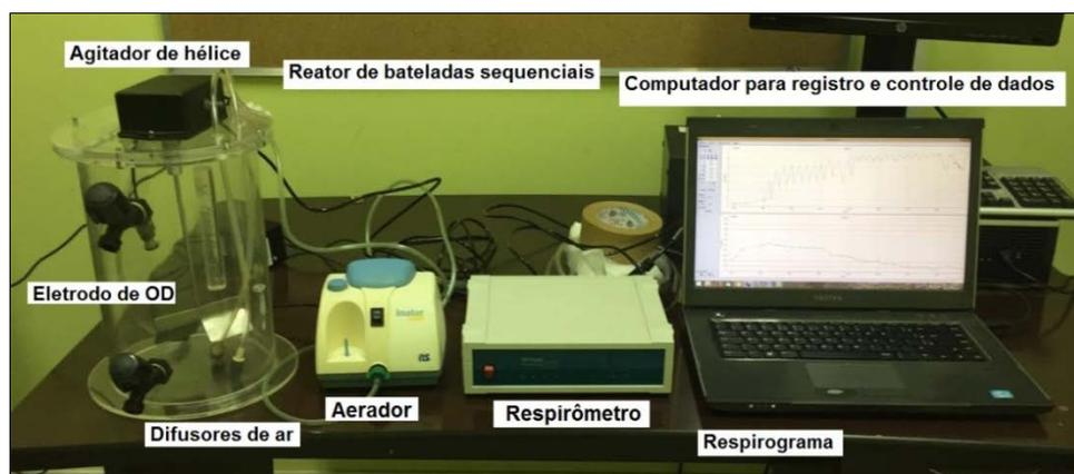
Figura 1: Equipamentos utilizados para realização dos testes respirométricos.
