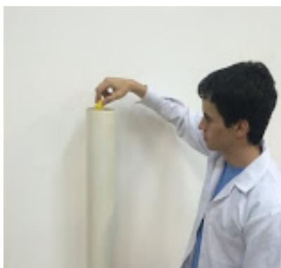
**Figuras 6: Preenchimento do RAHLF com os anéis para determinação da porosidade do leito.** Fonte: Acervo pessoal.
