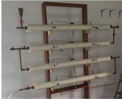
**Figura 2: Sistema composto pelos quatro RAHLF em escala piloto.**
