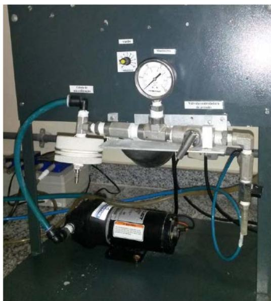
**Figura 5 – Equipamento utilizado para a determinação do SDI.**
