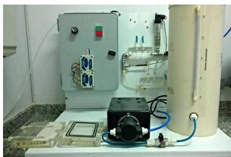
Figura 2: Célula de teste para determinação da permeabilidade das membranas para água desmineralizada.
