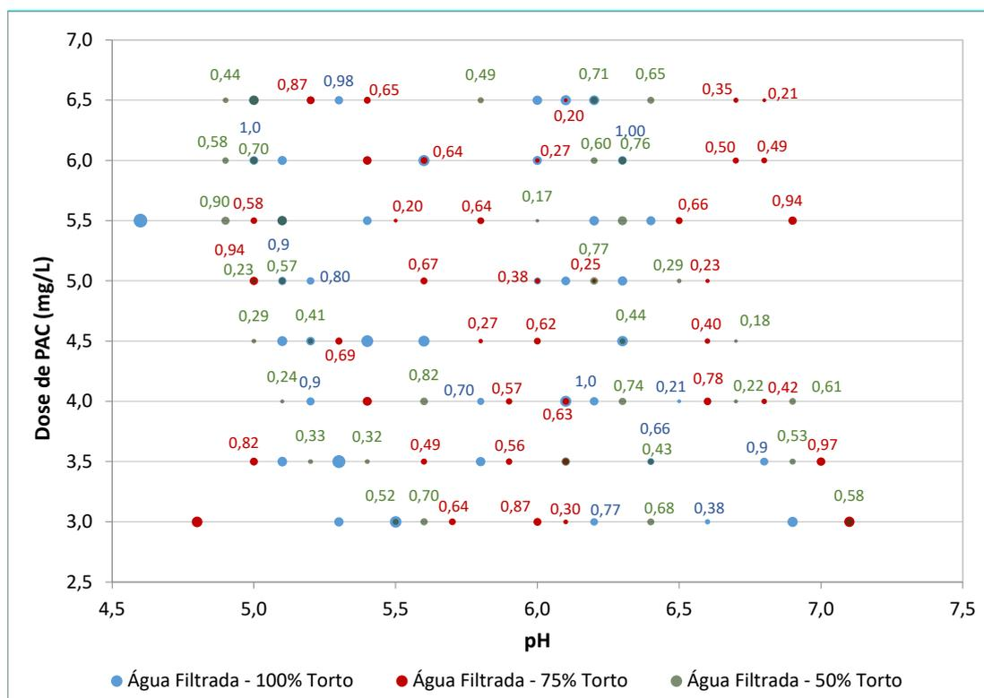
**Figura 3 – Residuais de turbidez da filtrada utilizando como água bruta: 100% de água do ribeirão Torto; 75% de água do ribeirão Torto + 25% de água do reservatório Santa Maria e 50% de água do ribeirão Torto + 50% de água do reservatório Santa Maria**
