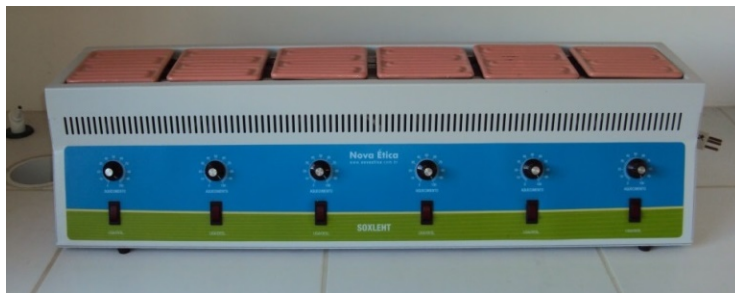
Figura 5 – Equipamento de aquecimento com resistência elétrica utilizado como carga
