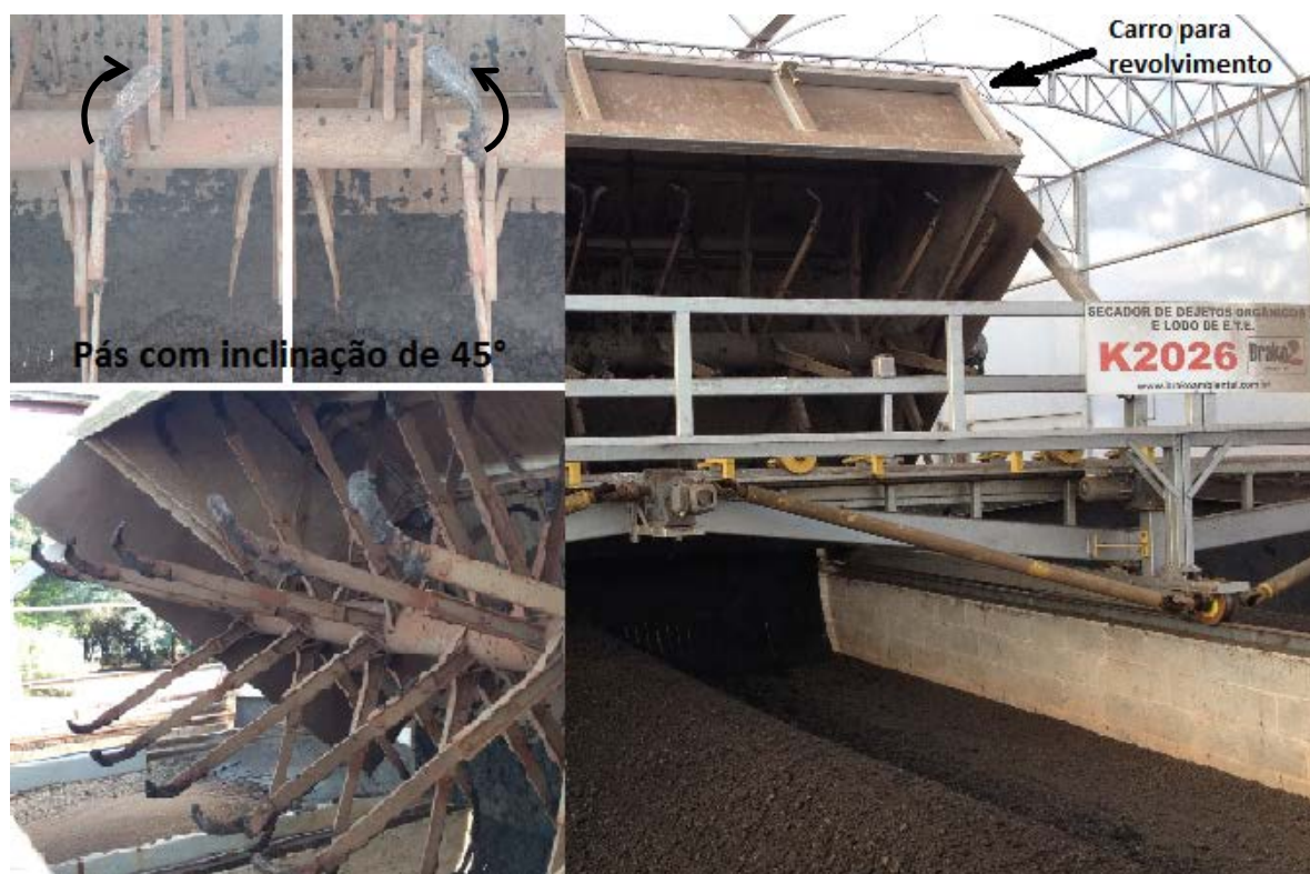
Figura 2 – Equipamento de mistura e pás modificadas.
