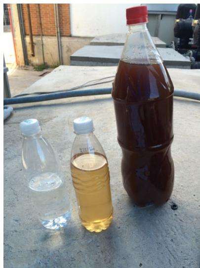
**Figura 5. Da esquerda para a direita, amostras de água de permeado, água de retrolavagem (alimentação) e concentrado do sistema de ultrafiltração.**
