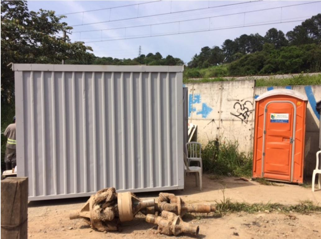
Figura 3. Alargadores de furo e demais insumos auxiliares utilizados para execução do furo. Fonte: Autor.
