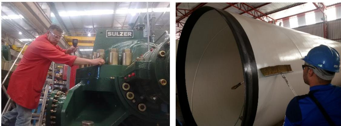
**Figura 7: Medição de espessura de película e teste de Holiday Detector, para detecção de falhas e porosidade nos revestimentos.**
