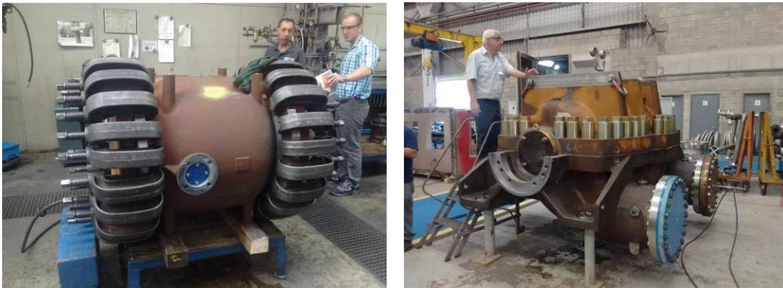
**Figura 1: Aplicação de Teste Hidrostático, corpo de válvula de fluxo anular e corpo de bomba, respectivamente.**
