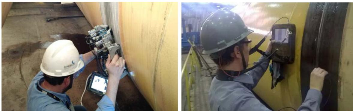
**Figura 8 – Inspeção de juntas soldadas por ensaio de ultrassom, respectivamente, processo automático computadorizado (Phased Array) e processo manual convencional.**
