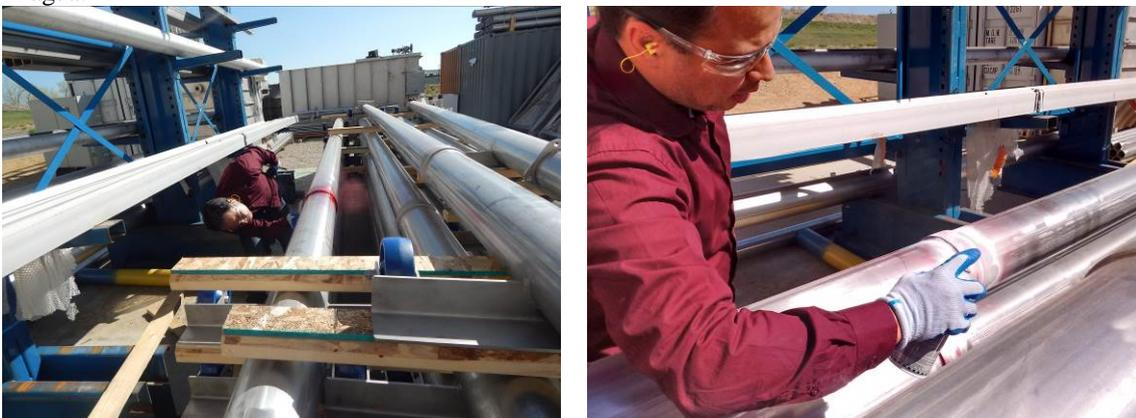
**Figura 6 – Ensaio de Líquido penetrante LP, sendo aplicado durante inspeção em fábrica.**
