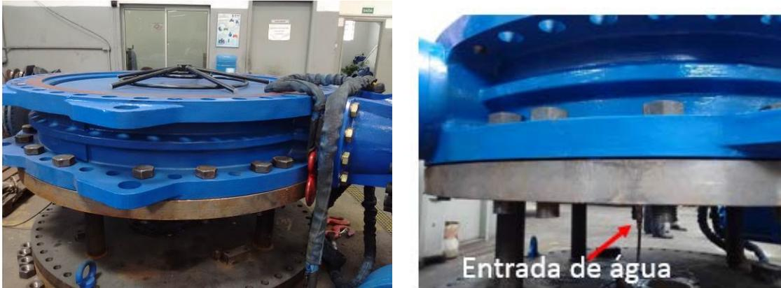
**Figura 3: Válvula borboleta de 1800 mm, sendo preparada para ser submetida ao teste de estanqueidade, destacando a entrada de água de teste, pela parte inferior.**
