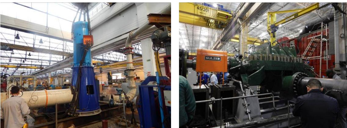
**Figura 2: Bombas de eixo vertical e de eixo horizontal sendo submetidas à teste de performance.**
