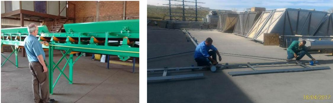
**Figura 5: Verificação dimensional, respectivamente, de um Transportador de Correia e Raspador de Lodo.**
