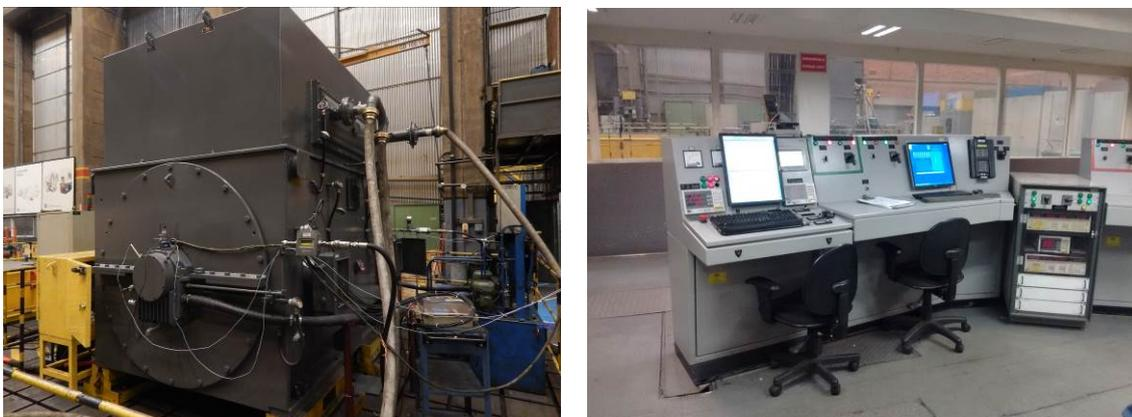
**Figura 4: Motor elétrico de 9100 cv e bancada de controle para realização de Teste Tipo.**
