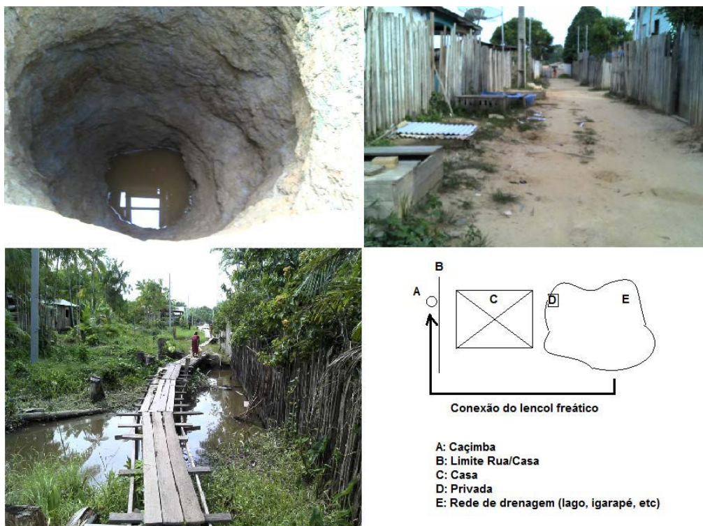
Figura 4: Esquema mostrando a conexão do lençol freático entre cacimba com rede de drenagem.
