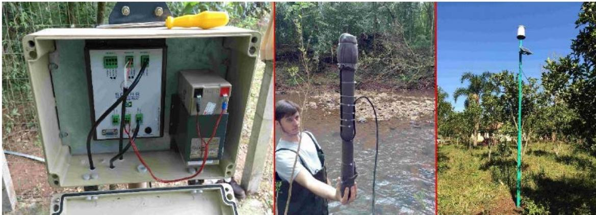
**Figura 2:** À esquerda, o *datalogger* alojado junto à bateria suplementar dentro da caixa hermética. No centro, o sistema de tubo de PVC envolto por tecido bidim em que o sensor de nível encontra-se acomodado no interior. À direita, o poste com o painel fotovoltaico e pluviômetro devidamente montados no campo.
